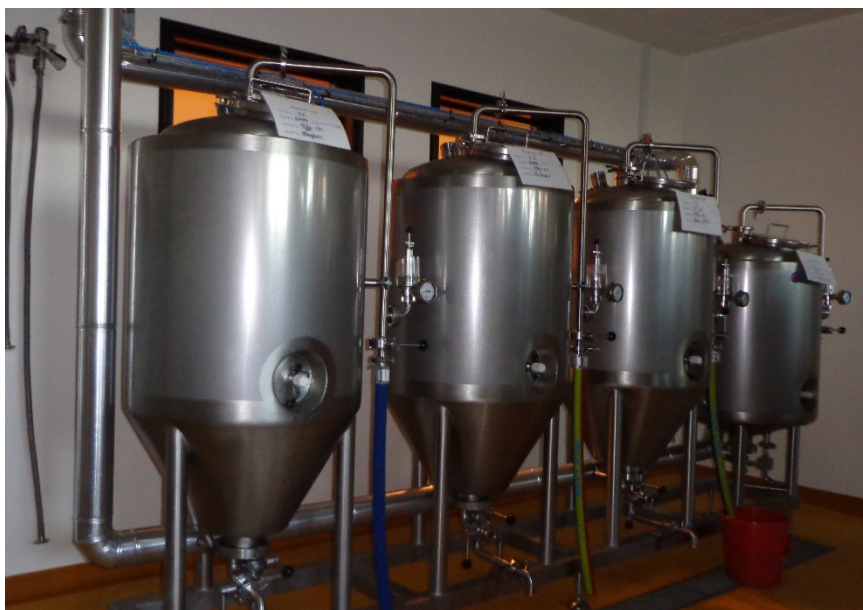
Fermenterings tanke og en tryktank for tank for et mindre brygger.
