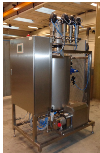
Komplet slam koger. Denne enhed er udviklet til at håndtere slammet fra en valle separator..
